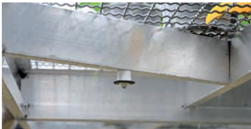
Jedes Rollbeet ist durch einen RFID-Datenträger TW-R30-B128 an der Unterseite eindeutig gekennzeichnet
