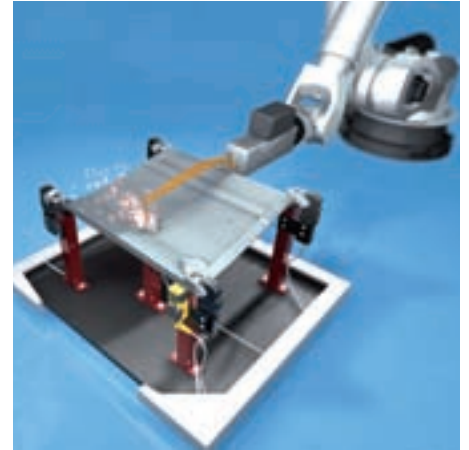
Nach Freigabe durch die SPS punktet der Schweißroboter die Muttern und Hülsen an das Blech
