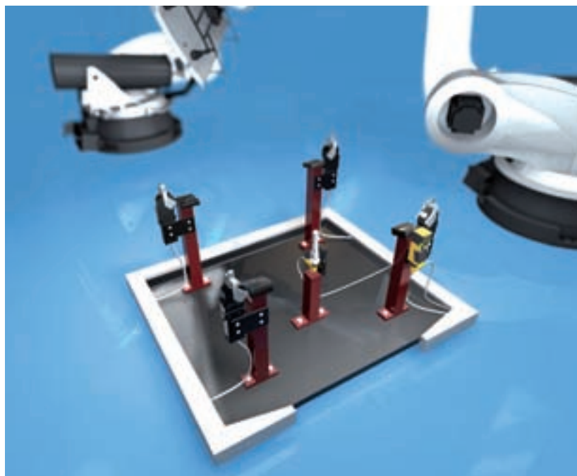
Die neuen Schweißmutternsensoren werden vor allem im Karosseriebau in der Automobilherstellung eingesetzt
