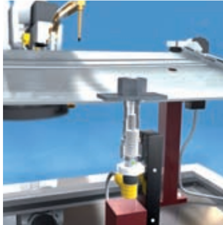
Nachdem der Werker eine Schweißmutter auf den Aufnahmebolzen gelegt hat, gibt der Sensor ein Signal an die SPS
