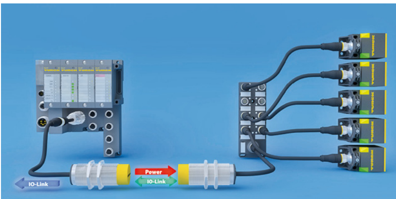
Lösung 3: Das Primärteil arbeitet als IO-Link-Master, sodass über den I/O-Hub (r.) bis zu acht Schaltsignale verarbeitet werden können
