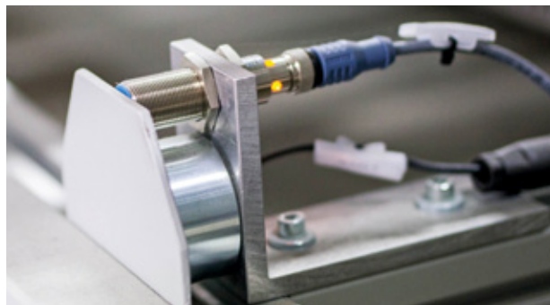
Die Signale des Sensors und des Elektromagneten werden direkt am Träger des Aufstellers auf das TBEN-S gelegt
