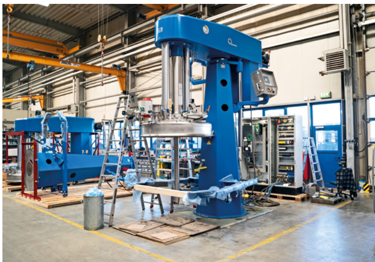
Von Melle in die weite Welt: Niemann rüstet Maschinen wie diesen Kreis-Dissolver mit Sensoren und Interface-Technik von Turck aus
