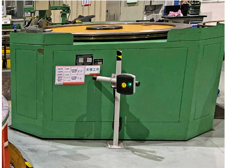
Ein programmierbares Gateway in Turcks BL20-I/O-System steuert die RFID-Reader dezentral – ein großer Vorteil in Anbetracht der zahlreichen Fertigungsstationen des Unternehmens
