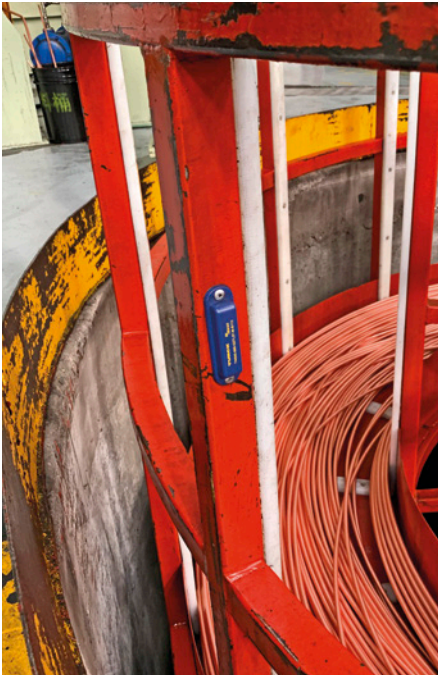
Der robuste UHF-Datenträger kann direkt am Metallrahmen montiert werden
