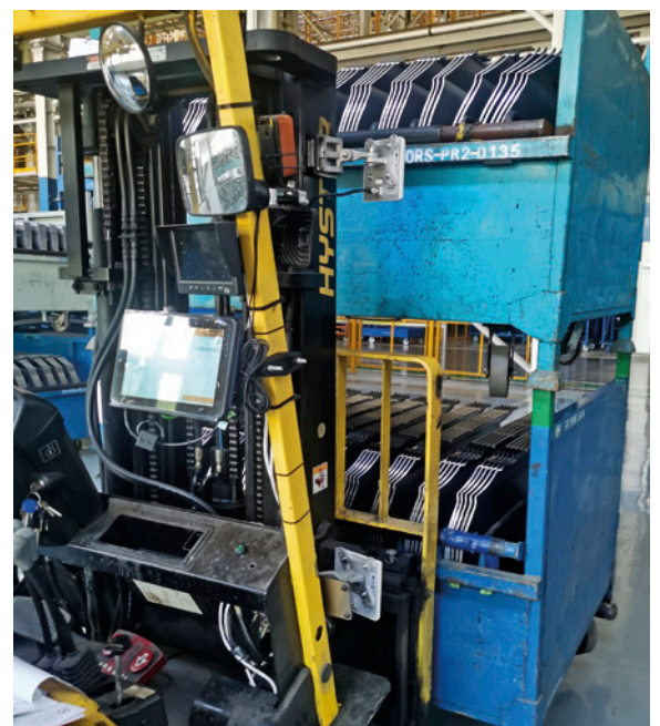
Die UHF-RFID-Antenne auf dem Stapler identifiziert die Behälter-ID und aktualisiert den Standort im WMS; die Transportaufträge werden direkt auf dem Monitor angezeigt
