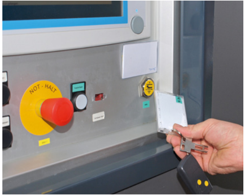
Der Mieter meldet sich mit seiner RFID-Chipkarte am Bedienpanel an – sein Boot wird innerhalb weniger Minuten einsteigsbereit „geliefert“
