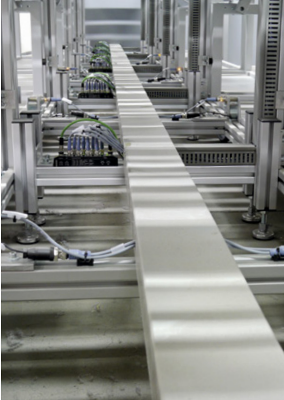
An jedem der fünf Aufsteller-Module befindet sich ein TBEN-S zur Aufnahme der Ein-Ausgangssignale der Sensoren und Aktoren
