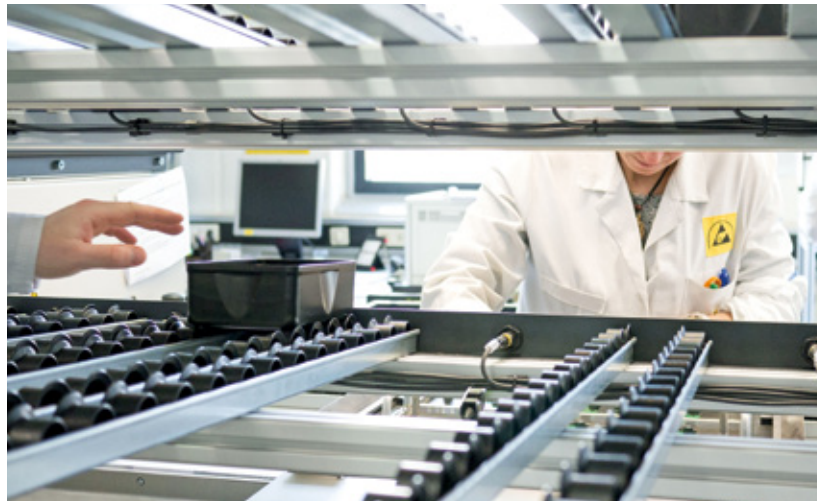
Die Regale können von hinten mit neuen Bauteilen bestückt werden, ohne den Produktionsprozess unterbrechen zu müssen
