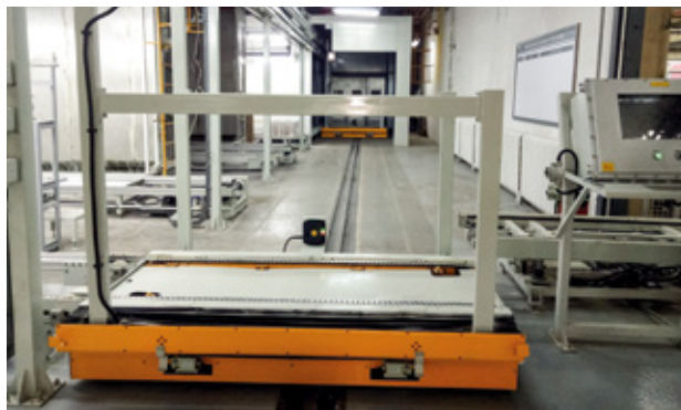
Mit Hilfe des Q175-Readers erfährt der fahrbare Schienentransporter, in welche Strecke einzelne Werkstücke eingliedert werden sollen
