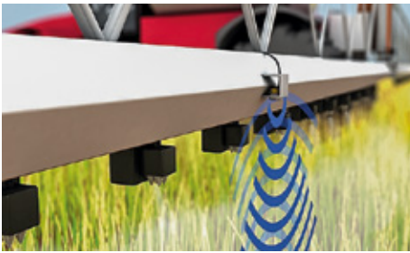
Turcks PTFE-beschichtete Ultraschallsensoren erfassen den Abstand zwischen Spritzgestänge und Acker oder Bestand und widerstehen dabei gängigen Pflanzenschutzmitteln
