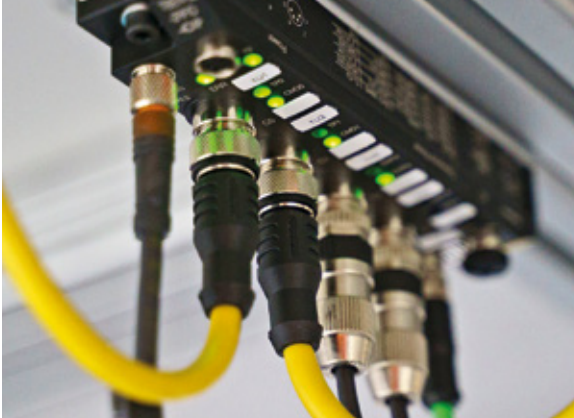
Turcks RFID-Interface TBEN-S-RFID spricht sowohl Profinet mit der Siemens-SPS als auch Ethernet/IP als Schnitt- stelle zu Labview an der Nacharbeitsstation
