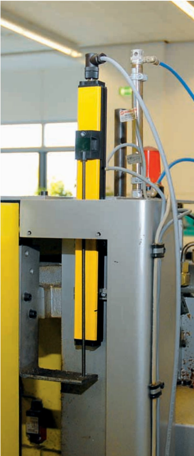
IP67: Im Gegensatz zu potenziometrischen Wegerfassungslösungen sind die LI-Sensoren absolut dicht und damit wartungsfrei
